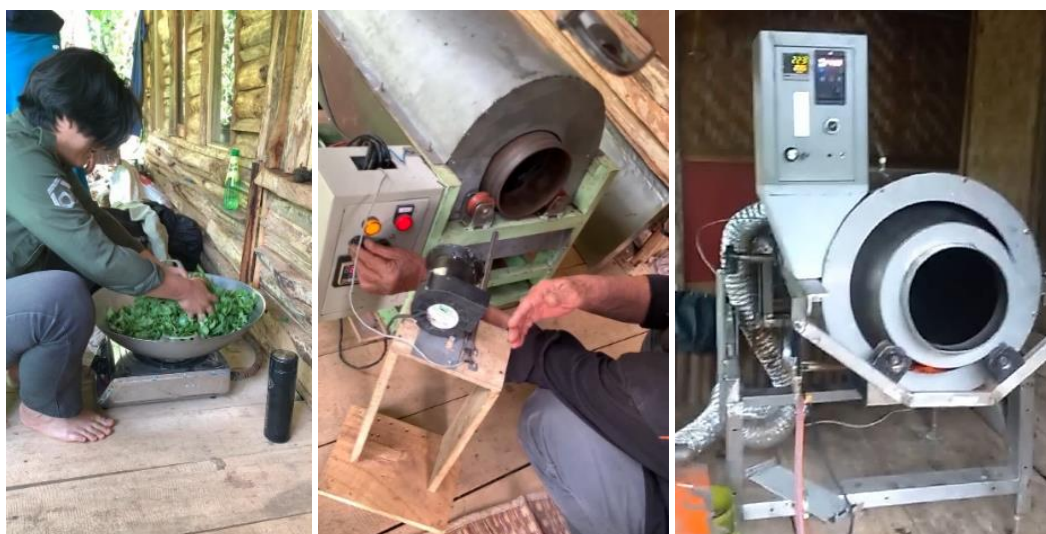
Gambar 3. Pengujian Mesin Roasting Teh Tradisional dan dengan Mesin Roasting
