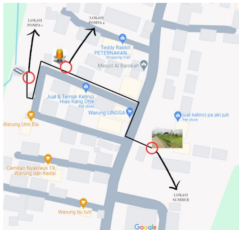
Gambar 12. Jalur kelistrikan dari sumber listrik kepada pompa-pompa air
