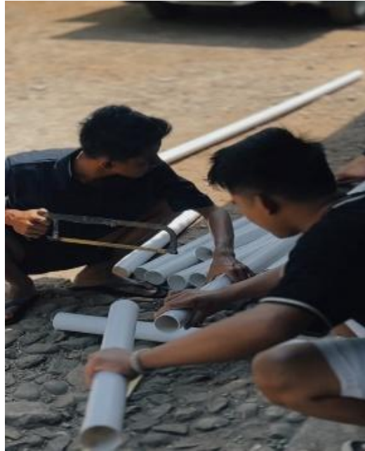
Gambar 1. Proses pemotongan pipa paralon
