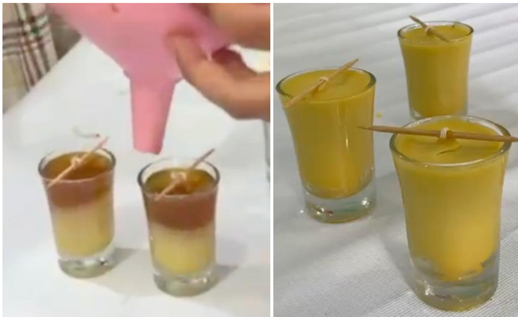
Gambar 4. Pencetakan lilin ke dalam jar. Warna coklat gelap adalah bagian lilin yang belum padat.
