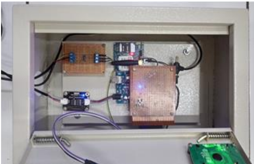
Gambar 3. Perangkat kirim data sensor menuju MQTT Broker
