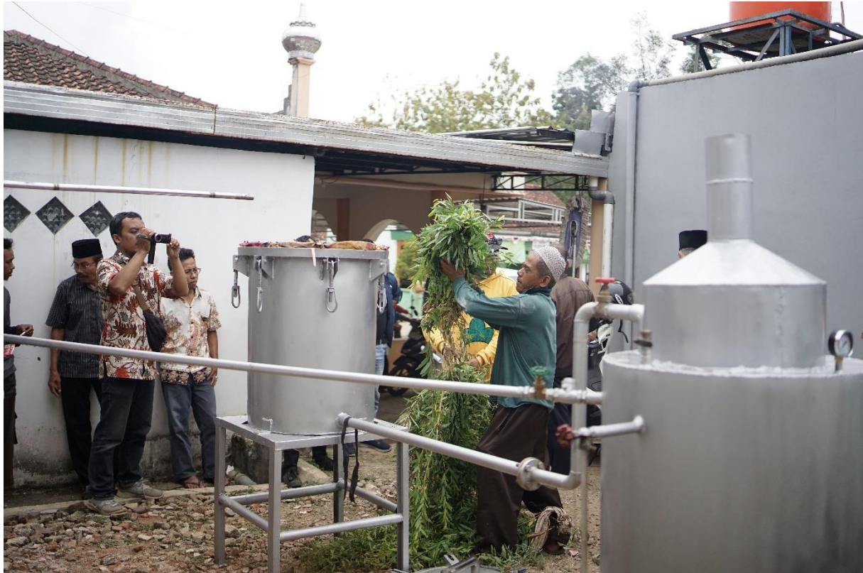
Gambar 4. Kelompok Tani Sarwo Tani Desa Sirkandi sedang mempraktekkan penggunaan teknologi tepat guna (mesin destilasi) untuk mengolah tanaman biofarmaka kayu putih menjadi minyak atsiri.
