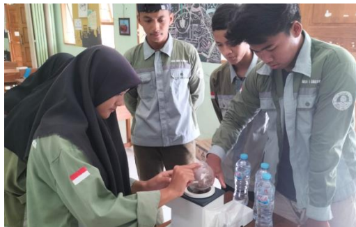
Gambar 3. Praktek pengujian kadar air pakan dengan menggunakan rapid moisture content tester
