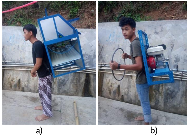
Gambar 5. Uji Coba Alat Pemisah Padi Portabel: a) Badan Utama b) Mesin Penggerak
