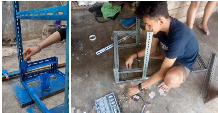
Gambar 3. Perakitan Penopang Mesin Penggerak Alat Pemisah Padi Portabel
