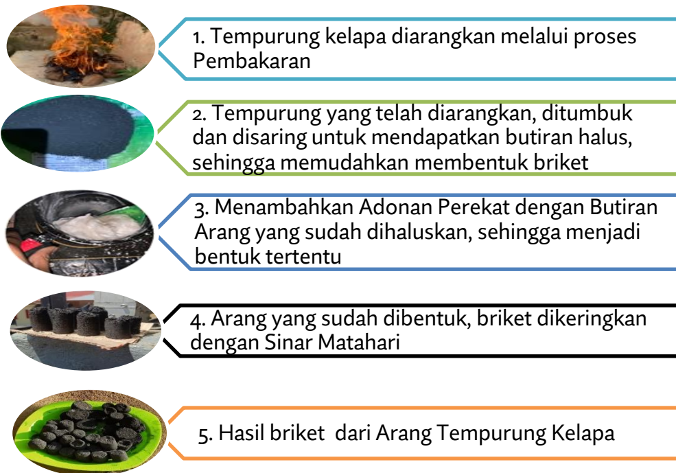
Gambar 1. Langkah-Langkah Pembuatan Briket dari Arang Tempurung Kelapa
